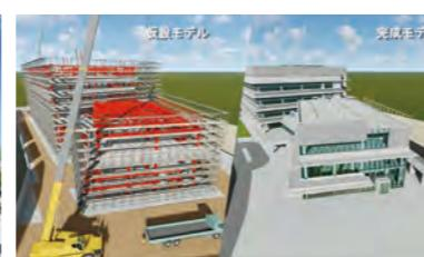
BIMで作成した完成モデルと仮設計画モデル
