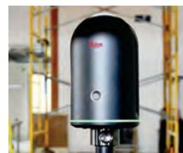
従来の方法では、複数の人員と作業日数の確保が必要な測量作業も3Dスキャナーを活用することで、1人で1時間程度のわずかな時間で測量が可能に。点群や画像などの必要なデータをすべて取り込み、高精度のデータを作成することができます。
